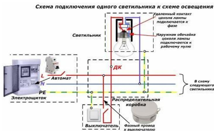
Рис.5 Схема подключения одного светильника к схеме освещения.
