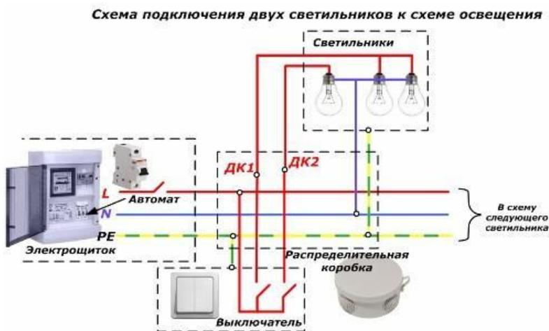
Рис.7 Схема подключения двух светильников к схеме освещения.
