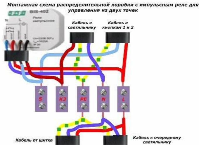
Рис.12. Монтажная схема распределительной коробки с импульсным реле для управления из двух точек.
