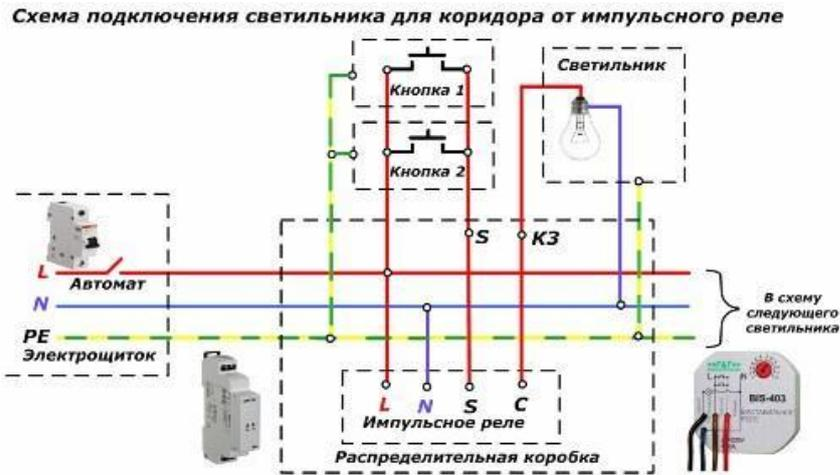
Рис.11. Схема подключения светильника для коридора от импульсного реле.
