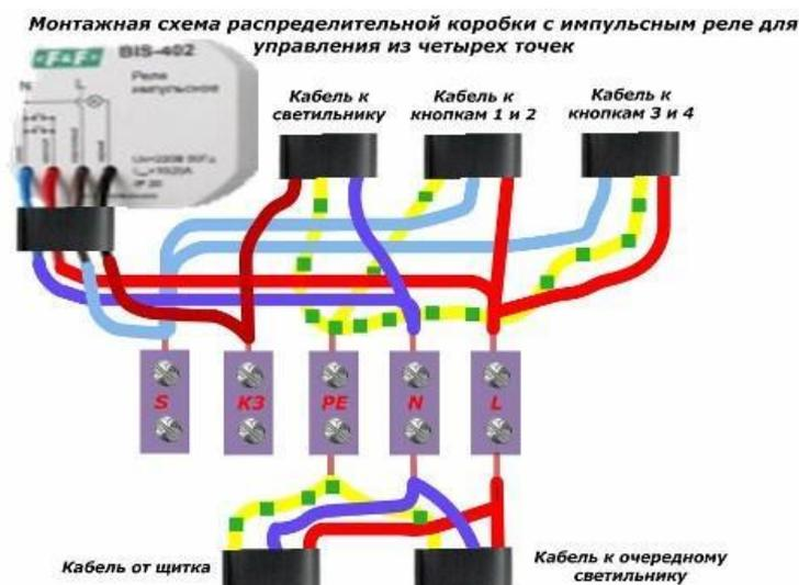
Рис. 14. Монтажная схема распределительной коробки с импульсным реле для управления из четырех точек.
