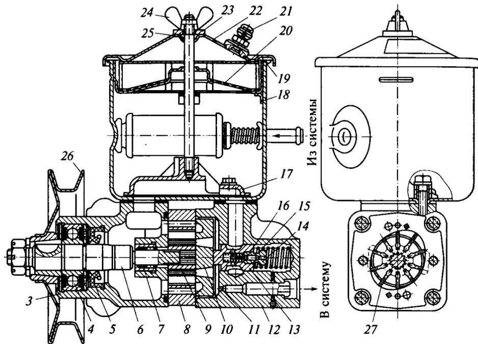
1, 13 – перепускные клапаны; 2, 20 – сетчатые фильтры; 3 – корпус насоса;
