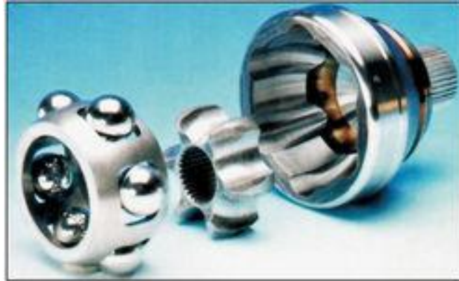
Рисунок 4 - Шестишариковый шарнир с делительными канавками
