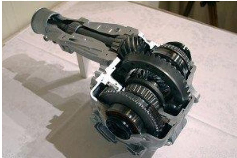
Рисунок 3 – Фотография редуктора переднего моста
