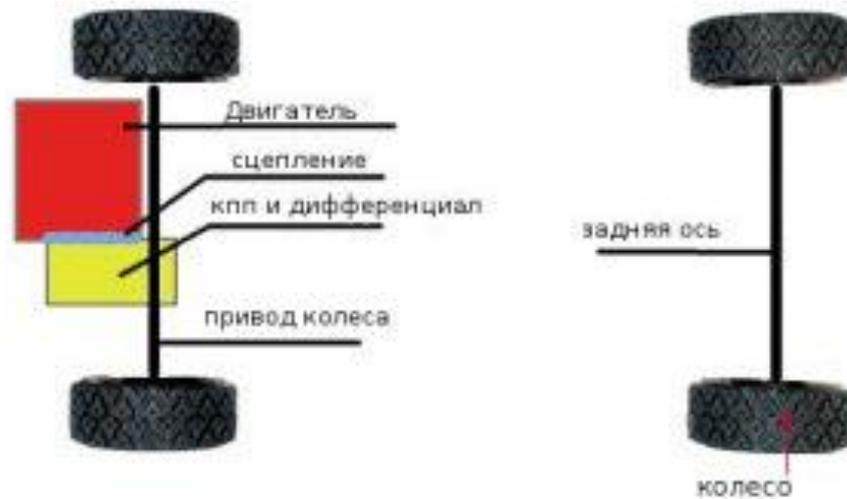
Рисунок 2 – Схема трансмиссии переднеприводного автомобиля
