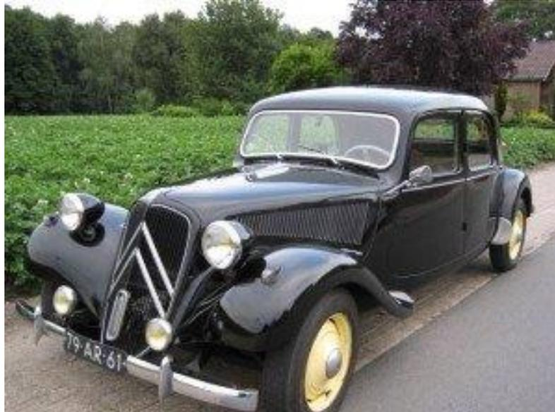
Рисунок 1 – Первый переднеприводный автомобиль
