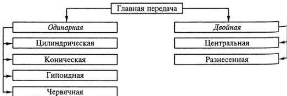
Рисунок 2 – Классификация главной передачи
