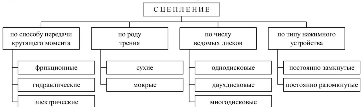
Рисунок 3 - Классификация автотракторных сцеплений
