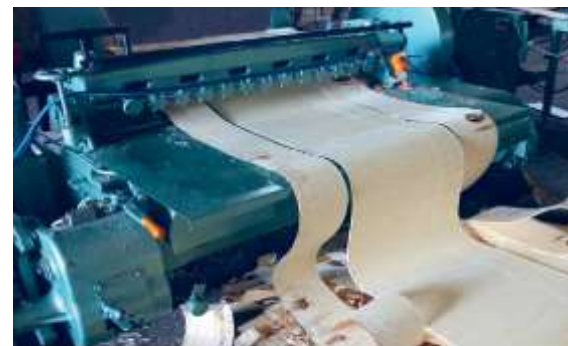
Использование лущильного станка (Германия) для производства мебельного шпона
