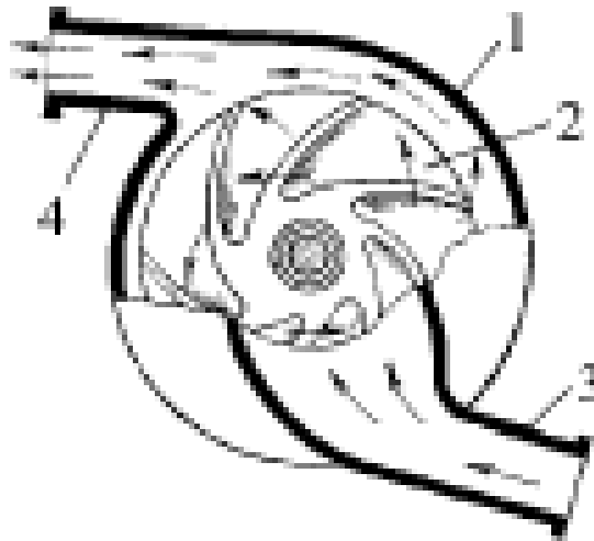
Рисунок 5 Центробежный насос: 1 – улиткообразный корпус; 2 – вращающееся колесо (крыльчатка); 3 – всасывающий канал; 4 – подводящий канал
