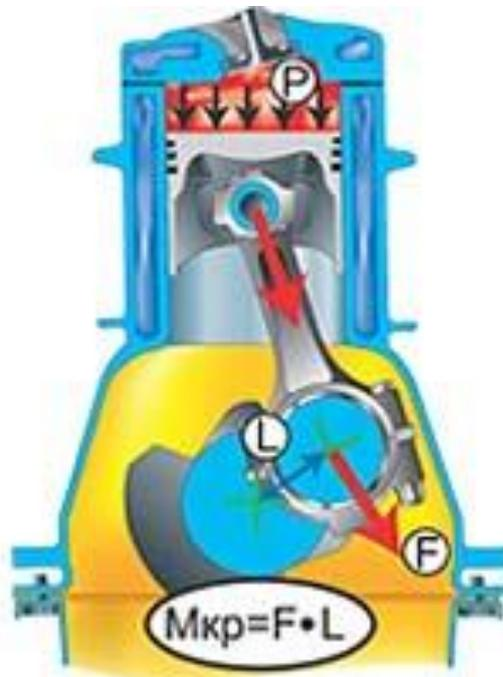
Рис. 3. Упрощенная схема сил, действующих в цилиндре: Мкр — крутящий момент, P — давление горячих газов; F — сила, создающая крутящий момент, L — плечо (радиус кривошипа).
